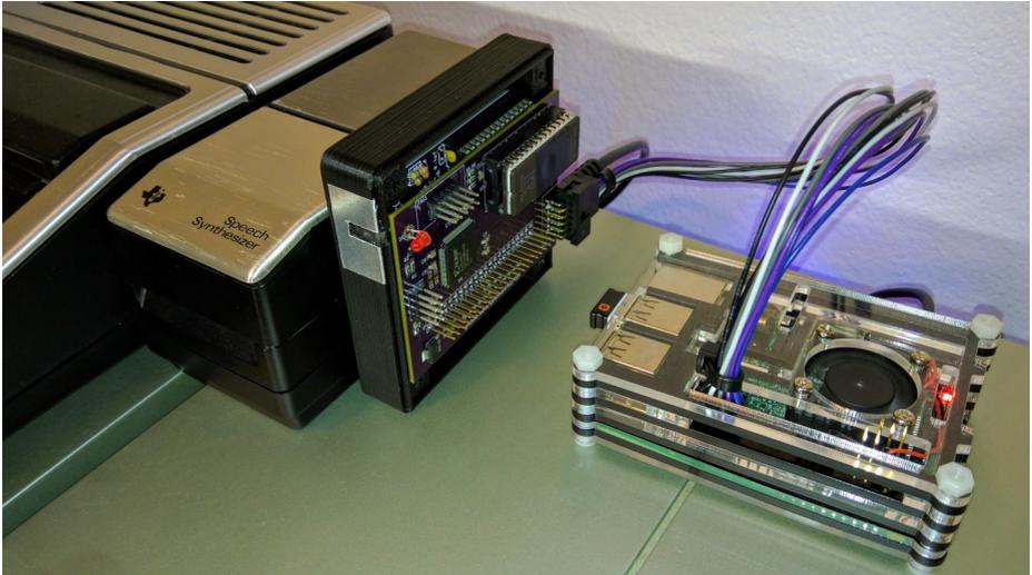
ist eine Erweiterung für die PEB Box oder zum Direktanschluss von Jedimatt42. Sie verbindet den 99/4A mit einem Raspberry Pi und ermöglicht die Nutzung des Minicomputers als Festplatte. Weiterhin ist der Zugriff auf die Netzwerk- und On-
